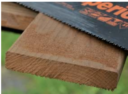
Värmebehandlad ask som både bastulav och golv.
