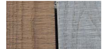
Ask före och efter exponering i naturlig UV strålning.
