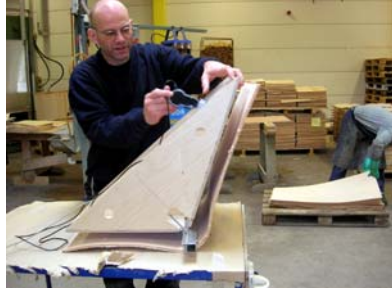
Bild 3. Lasse mäter återfjädring och skevhet
